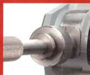
Excenterskive tredobler udnyttelsen af diamant- skiven.
