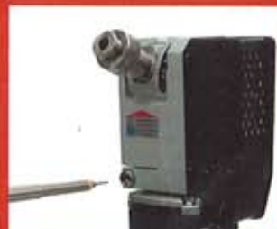
Præcis længdebestemmelse af elektrodens stick-out.
